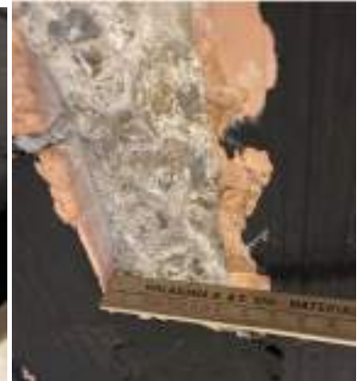
Figura 6 – Saggi effettuati ai solai per determinare il copriferro
